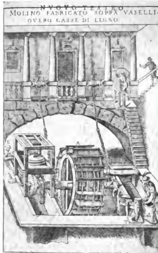
Abb. 74. Schiffsmühle zum Mahlen und Stampfen, 1607.
